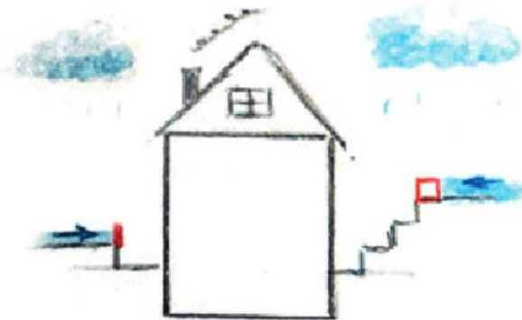
Abbildung 32 Schutz tiefliegender Gebäudezugänge [8]
